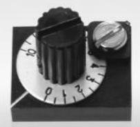
Ce cadran comporte une embrase en nylon noir servant de support à une vis de blocage et à un repère de lecture. L'embrase se fixe sur la douille filetée du potentiomètre à l'aide de l'écrou à fente. Un ergot de Ø 3 mm à 8 mm d'entraxe assure le positionnement de cette embrase. Avec chaque cadran est fourni un écrou à fente de Ø 6 pas 75 pour l'alésage 3 ou Ø 1/4" filets pour l'alésage 1/8". Il est prévu une clé pour ces écrous.
