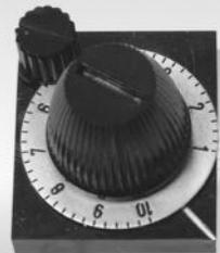
Ce cadran comporte une embrase en nylon noir servant de support à une vis de blocage et à un repère de lecture. L'embrase se fixe à l'aide de l'écrou du potentiomètre. Un ergot de Ø 3 mm à 12 mm d'entraxe assure le positionnement de cette embrase. Le cadran gradué est fixé sur le bouton par 3 vis. Il peut ainsi être positionné correctement si l'axe du potentiomètre comporte un plat.
